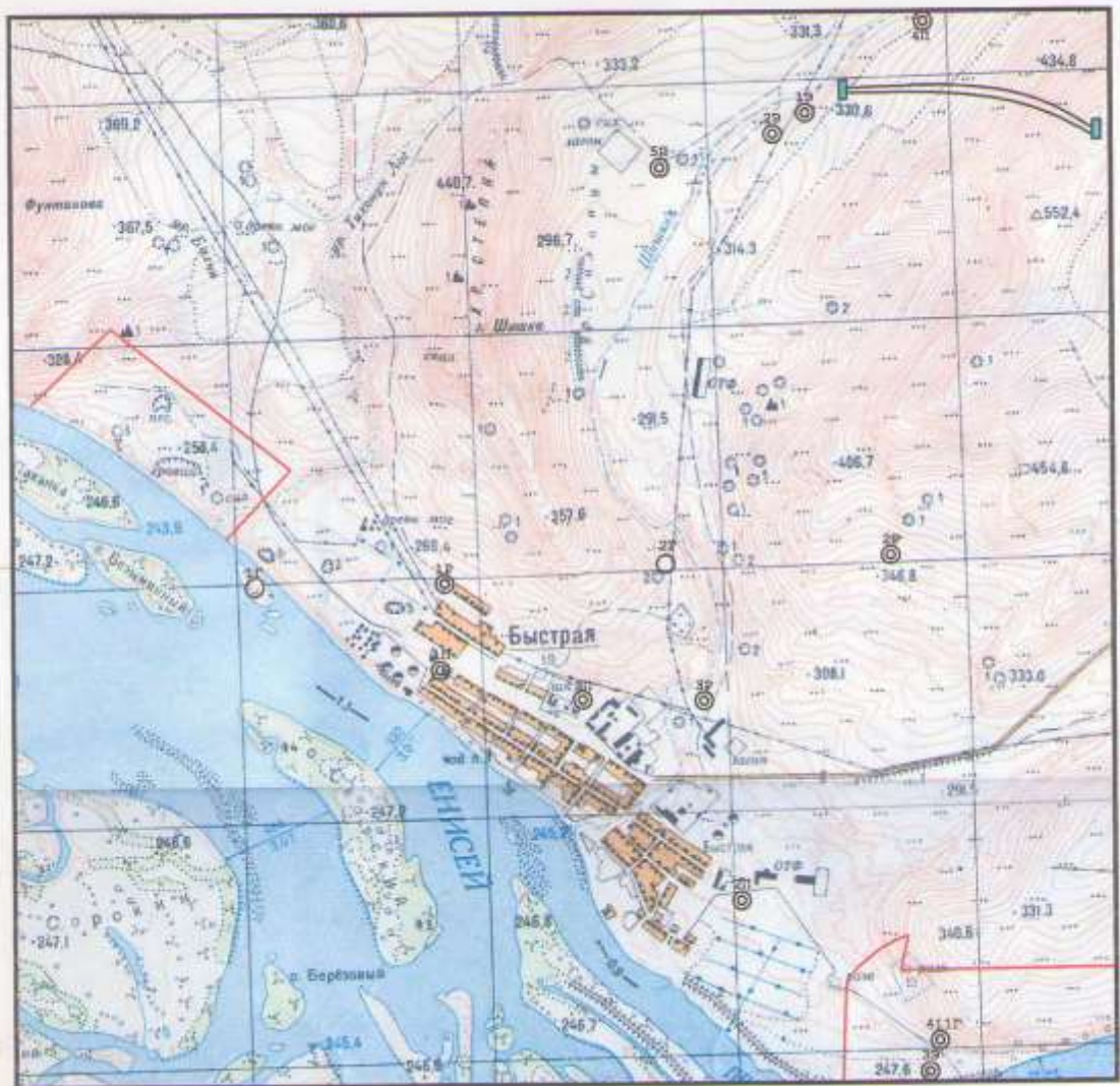
Рис. 1. Схема размещения эксплуатационных, поисковых скважин и проектных участков работ в с. Быстрой.
