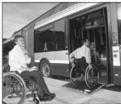
Пример применения механической аппарели автобуса на посадочной площадке в габаритах места посадки инвалидов
