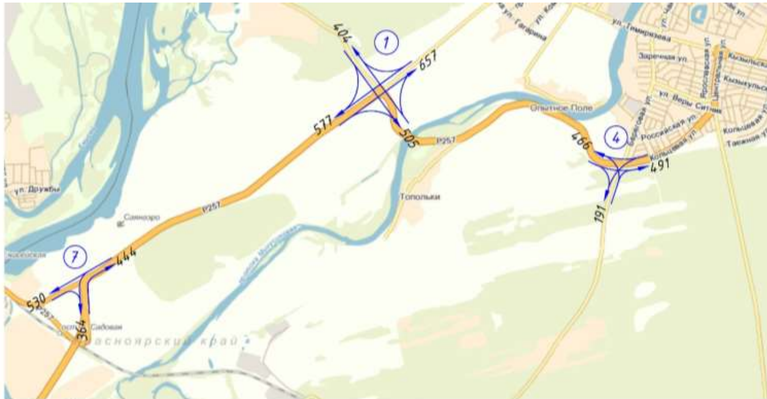
Интенсивность движения на участках УДС в вечерний «час-пик» для транспортных узлов 1, 4 и 7
